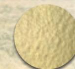
Die Wände sind mit **Polyurethanschaum (PS)** isoliert, einem Material, das eines der **besten Verhältnisse zwischen Stärke, Aufwand und Leistung** bietet. Der Fußboden besteht aus einer Sandwich-Struktur, während das Dach mit Polyesterfaser isoliert und mit Aluminiumfolie abgedeckt ist.
