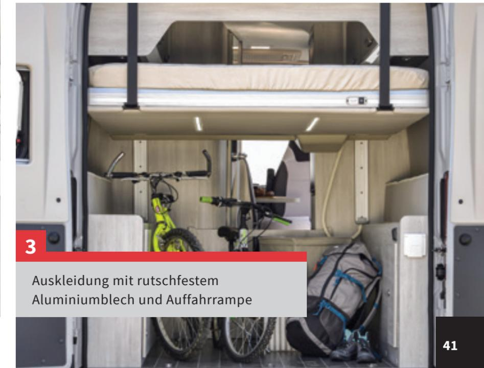
3 Auskleidung mit rutschfestem Aluminiumblech und Auffahrrampe
